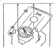
б) вращение кольца градуированной шкалы компаса для установления рисок, нанесенных на капсуле, параллельно линиям магнитного меридиана;
